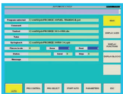
Menu automatico: permette la produzione di parti in automatico, la selezione di un programma (con l'ausilio grafico), la visualizzazione delle posizioni degli assi, ecc.
