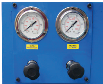
Controllo indipendente morsa e slitta
