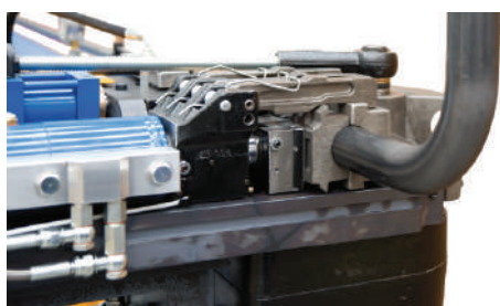
Dettaglio del sistema di serraggio tubo
