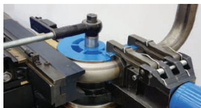
Sistema di chiusura "a dita" FST
