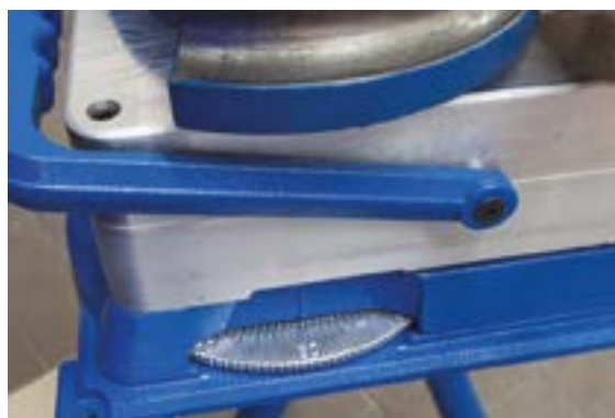
Disco graduato per la misurazione dell'angolo di curvatura
